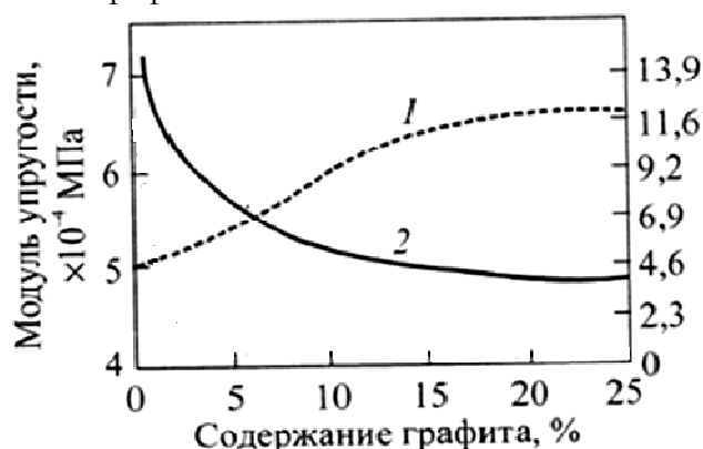
Рис. 1. Влияние содержания мелкодисперсного графита на свойства огнеупорных изделий (1 – теплопроводность; 2 – модуль упругости)
