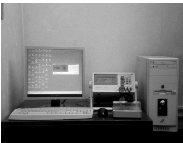
Рис.1. Малогабаритный цифровой прибор для контроля и диагностики комплекса диэлектрических свойств пластинчатых изоляционных материалов в диапазоне частот электрического поля 50 Гц – 1 МГц
