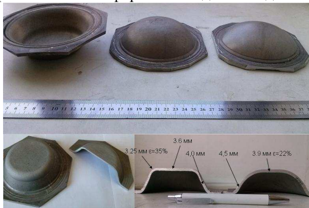
Рис.1. Модельные детали куполообразной формы из сплава 1565
