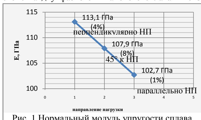
Рис. 1. Нормальный модуль упругости сплава ВТ6-С в зависимости от направления вырезки образцов
