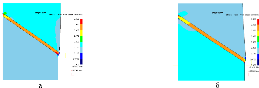
Рис. 1. Распределение деформаций в области никелевой прослойки при \alpha = 45^\circ : а) титан сверху, сталь снизу; б) сталь сверху, титан снизу.
