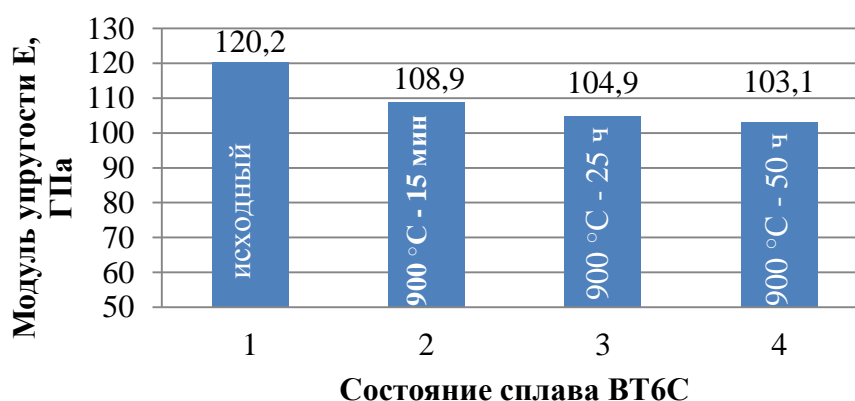
Рис. 1. Изменение нормального модуля упругости сплава ВТ6С после отжига (900 °С)
