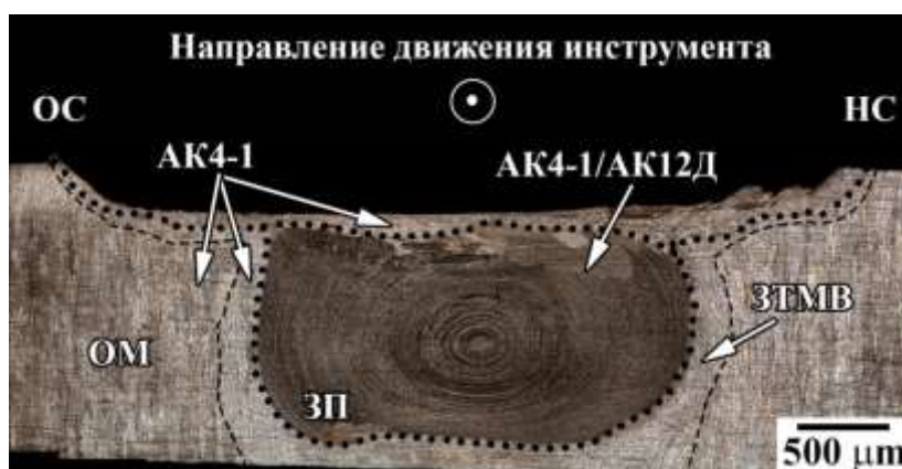
Рис. 1. Макростроение алюминиевого сплава АК4-1 после замешивания в него сплава АК12Д обработкой трением с перемешиванием при скоростях деформации \omega=1000 об/мин и v=30 мм/мин. НС – наступающая сторона, ОС – отступающая сторона, ЗП – зона перемешивания, ЗТМВ – зона термомеханического влияния, ОМ – основной металл (исходный сплав). Оптическая металлография.
