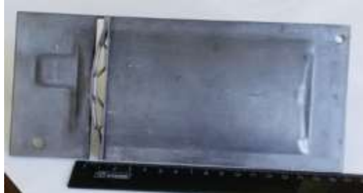
Рис.1. Гофрированная конструкция с УМЗ наполнителем из титанового сплава ВТ6
