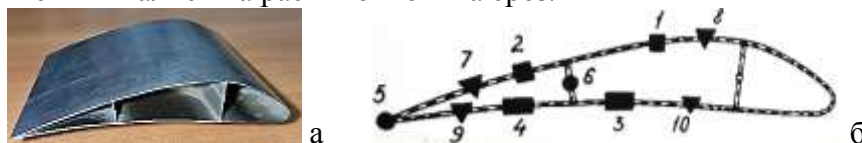
Рис. 5 Изделие WING SLAT- а и схема вырезки образцов для механических испытаний – б.
