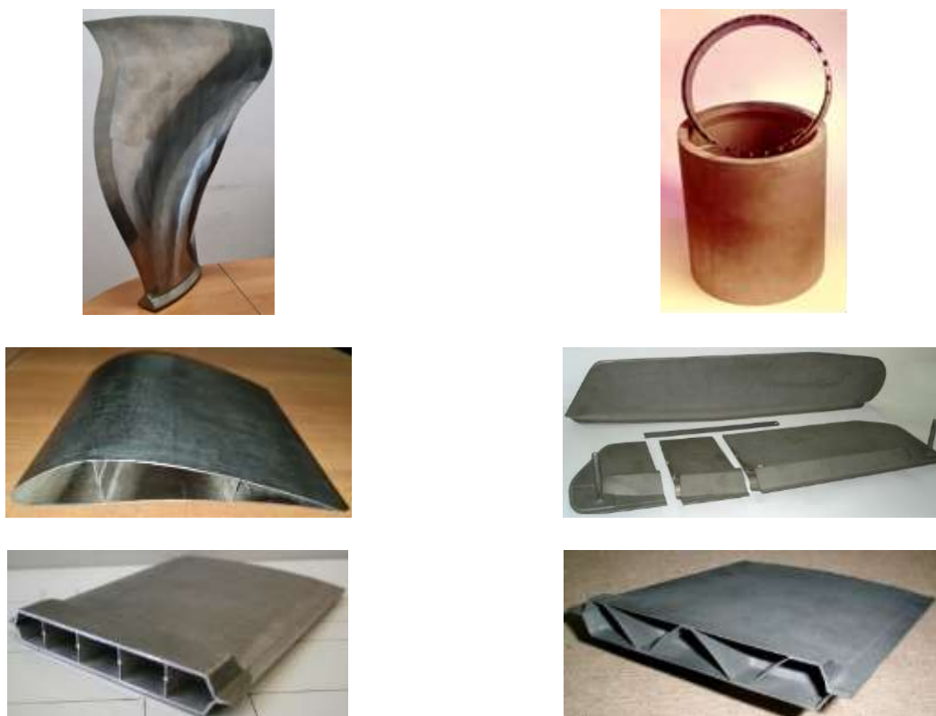
Рис. 4. Изделия, полученные по технологии СПФ/ДС в ИПСМ РАН
