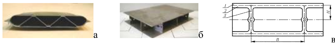
Рис. 1. Образцы трехслойных (а) и четырехслойных конструкций (б), в - схема четырехслойной ячеистой конструкции: 1 – обшивка; 2 – наполнитель; 3 – ребро жесткости (В и Н – ширина и высота ячейки).
