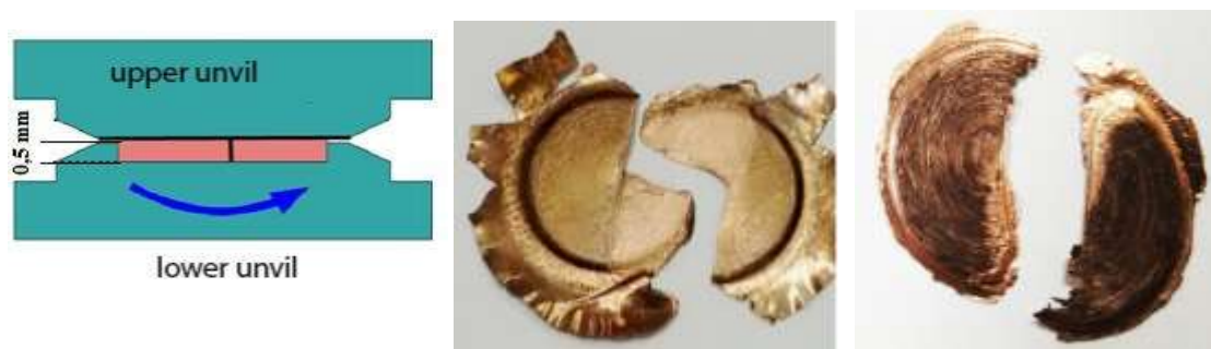
Рисунок 1. (а) Схема «совместного ИПДК двух половинок» для определения проскальзывания при ИПДК; (б) вид половинок Cu после совместного ИПДК n=1/4 (показывает отсутствие проскальзывания); (с) образец Cu после ИПДК n=10 , разрезан на половинки, и те же половинки после последующего совместного ИПДК n=1 (вид половинок показывает эффект тотального проскальзывания)
