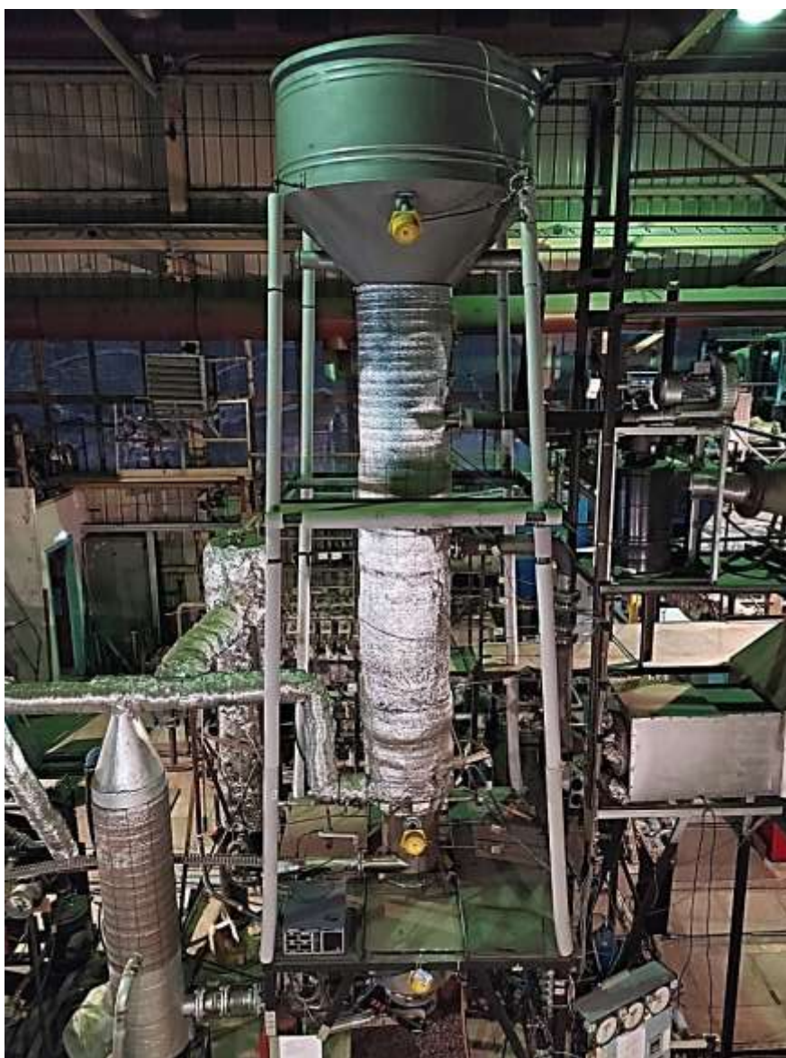
Рис. 1. Пилотная установка торрефикации биомассы
