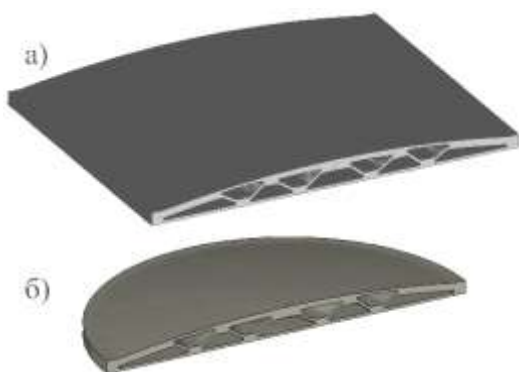
Рис. 1 Трехслойная полая конструкция, формируемая в условиях а) плоско-деформированного состояния, б) осесимметричного напряженного состояния.
