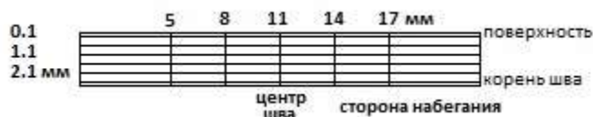
Рис. 2. Схема расположения точек на образце, в которых измерялась микротвердость.
