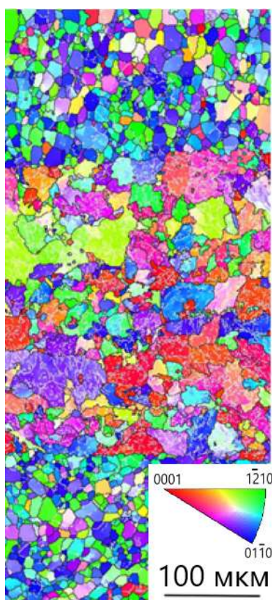
Рис.1. Микроструктура образца, полученного УЗС P=5 кН, t=2 с.
