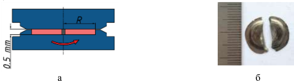
Рис. 1. Схема совместной ИПДК двух половинок (а); внешний вид образца после ИПДК n = \frac{1}{4} (б).
