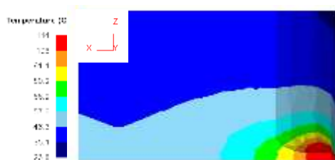
Рис. 2. Результаты моделирования распределения температуры в магнии в очаге деформации.
