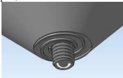
Рис. 1. Модель инструмента для ОТП. Направление вращения наконечника показано стрелкой.
