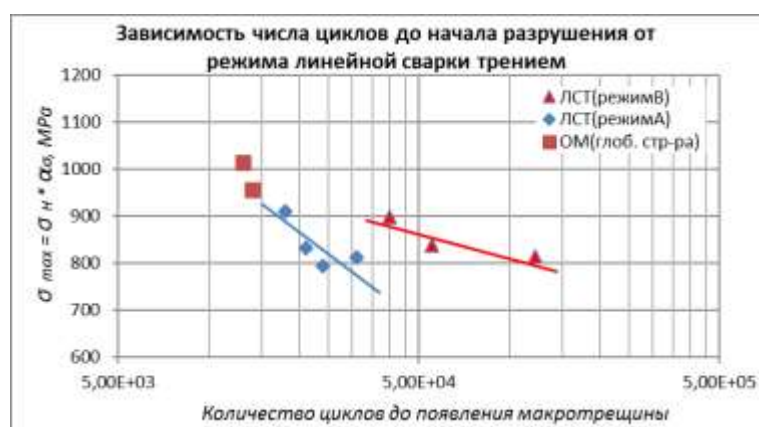
Рис. 3. Влияние режима линейной сварки трением на зарождение трещины усталости
