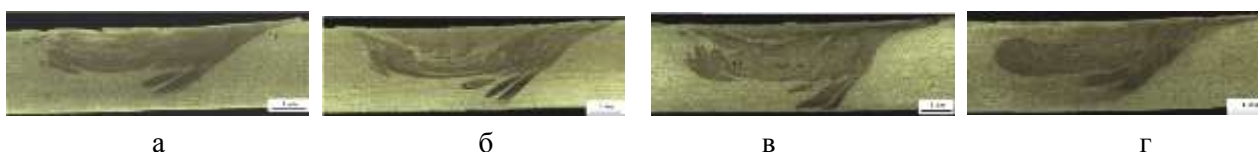
Рис. 4. Составное макроскопическое изображение образцов, обработанных наконечником разной длины: 1.6 мм (а), 1.8 мм (б), 2.0 мм (в), 2.2 мм (г).
