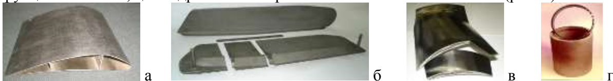
Рис. 4. Изделия, полученные по технологии СПФ/ДС в ИПСМ РАН: панель (а), крыло (б), лопатка имитатор (в), цилиндрический корпус (г).
