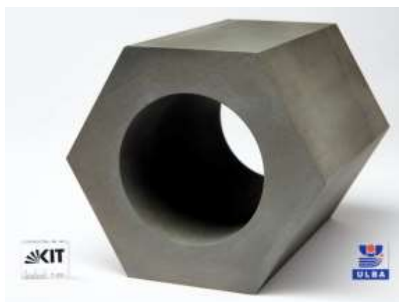
Рис. 2. Полноразмерный блок из бериллида титана, изготовленный в кооперации Технологического института Карлсруэ и Ульбинского металлургического завода
