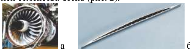
Рис. 2. Вентилятор двигателя фирмы Rolls-Royce с полыми лопатками (а), сечение полый лопатки (б).
