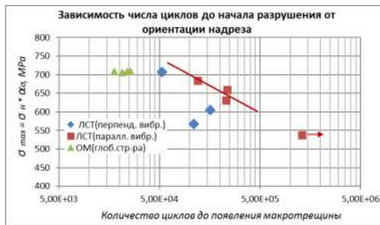
Рис. 2. Влияние ориентации надреза на зарождение трещины усталости
