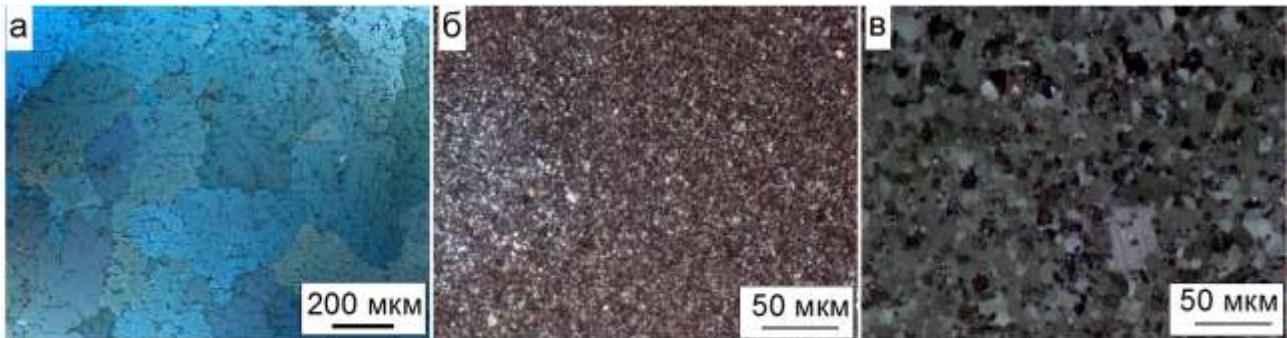
Рис. 1. Микроструктура сплава в гомогенизированном состоянии (а), после 5 циклов ВИК при 350°C (б) и после ВИК и отжига при 540°C 20 мин (в)
