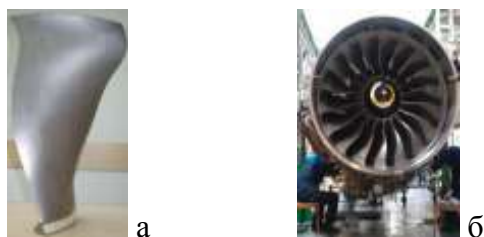
Рис. 5. Полая широкохордная рабочая лопатка вентилятора (а) и сборка двигателя-демонстратора ПД-14 в ПАО «Авиадвигатель» (б).
