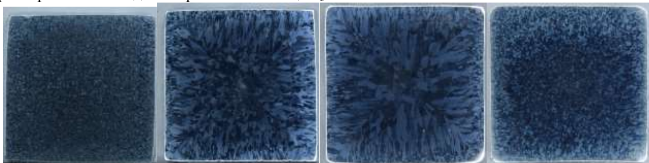
Рис. 1. Макроструктура литых сплавов Al-2.5Mg с содержанием 0.1Sc+0.22Zr (а), 0.12Sc+0.20Zr (б), 0.14Sc+0.18Zr (в) и 0.2Sc+0.12Zr (г)
