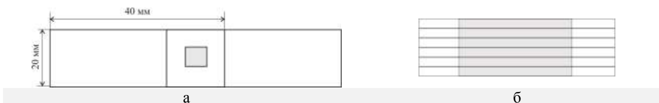
Рис. 3. Схема образцов для испытаний на срез (а) и консолидированных образцов для исследования микроструктуры (б), полученных УЗС; серым цветом выделены участки, подвергнутые сварке
