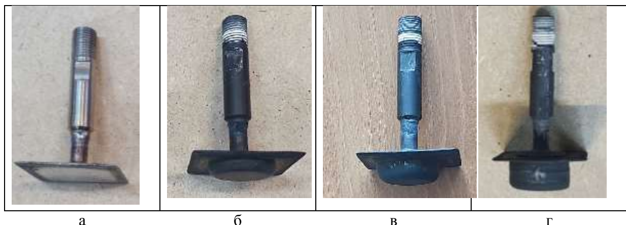
Рис. 2. Образцы до (а) и после СПФ при T=850^\circ\text{C} (Н - глубина формовки б – H=5 мм; в - H=10 мм; г – H=15 мм)
