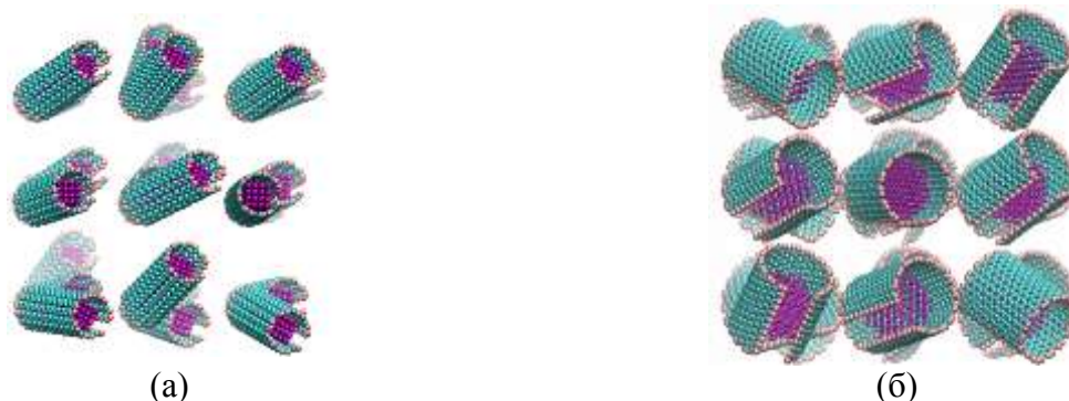
Рис. 1. Исходная структура скомканного графена с разной хиральностью структурных элементов: (а) УНТ (7,7) и (б) УНТ (15,15). Длина УНТ составляла 2,5 нм.
