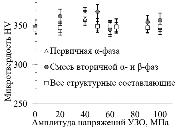
Рисунок 3.5 - Зависимость микротвердости структурных составляющих образцов ВТ6, подвергнутых РКУП, от амплитуды осциллирующих напряжений УЗО
